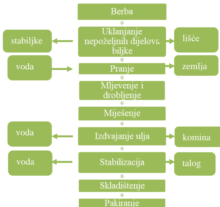
Slika 5. Opća tehnološka shema proizvodnje maslinovog ulja
