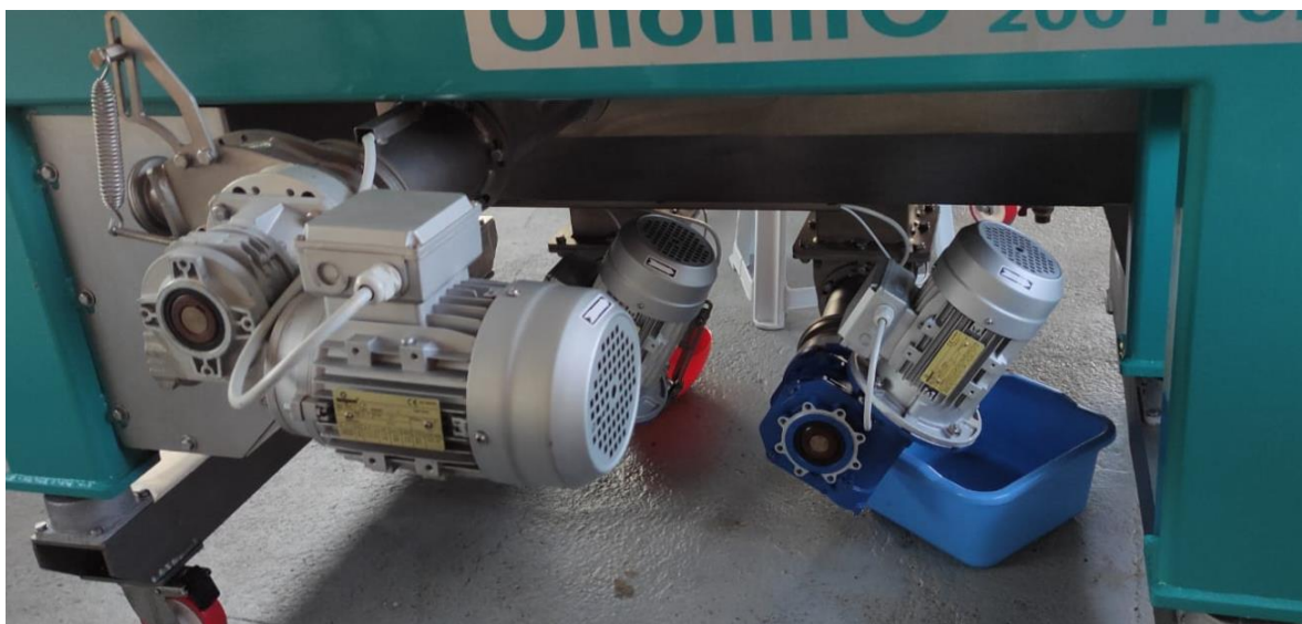
Slika 13 – dio Olimio Profy 200 stroja za centrifugalnu ekstrakciju u 2 faze (izvor: vlastita fotografija)
