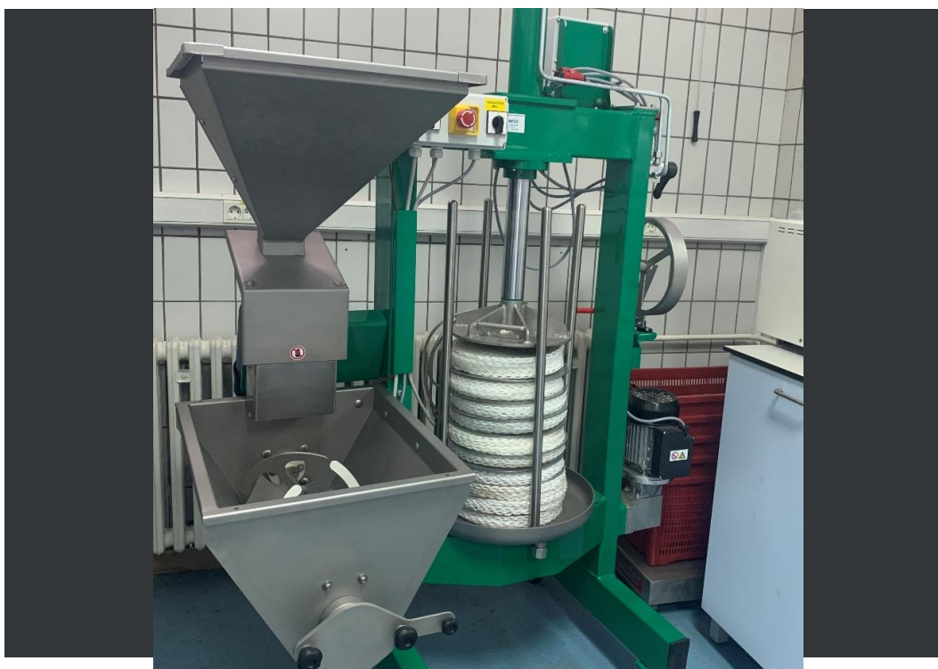
Slika 1. Uljara Oleum 30 Compact (vlastita fotografija)
