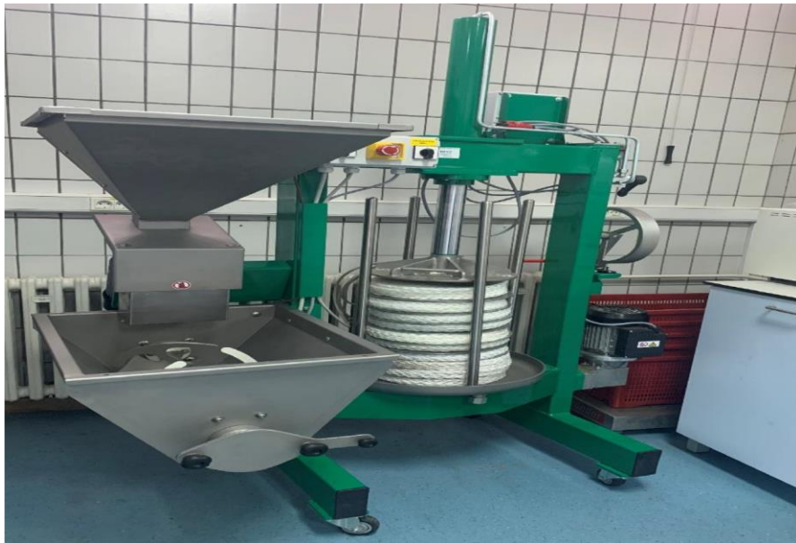
Slika 5. Uljara Oleum 30 Compact (Vrbica, 2023)
